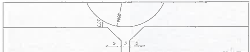
Rys. 2 | Pionowy uskoki w [mm] na łączeniu kostek fazowanych pod kołem 24"
