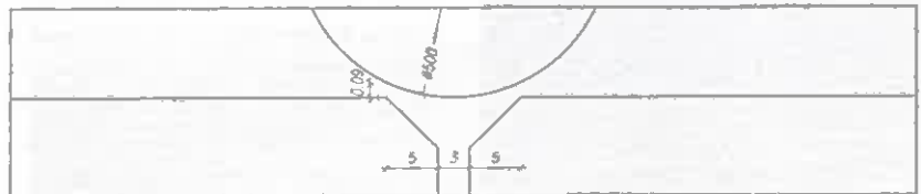
Rys. 3 | Pionowy uskoki w [mm] na łączeniu kostek fazowanych pod kołem 20"
