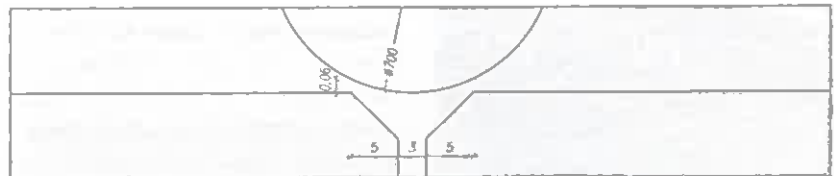
Rys. 1 | Pionowy uskoki w [mm] na łączeniu kostek fazowanych pod kołem 28"
